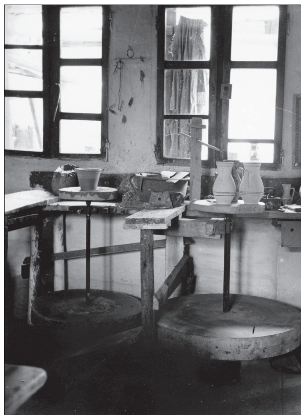
3. ábra Fazakasműhely Kézdivásárhelyt két koronggal, a bal oldali csere-, a jobb oldali fenyőfából készült, az előbbi régebbi
